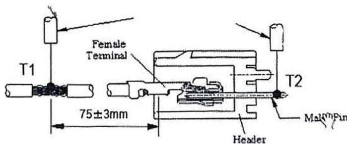
图 4. 接触电阻测试方法
